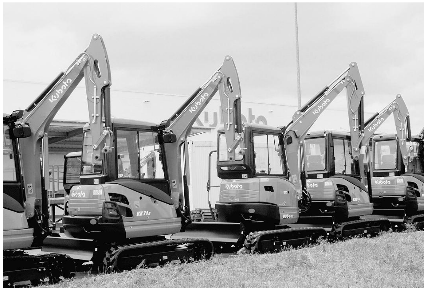
„made in Zweibrücken“: Die Produktpalette der Kompaktbagger aus Zweibrücken und Japan reicht vom kleinen K008-3 mit einem Einsatzgewicht von 980 kg bis zum neuen KX080-4 mit einem Gewicht von bis zu maximal 8700 kg. Im werkseigenen Stahlbau werden Ober- und Unterwagen, Planierschilde, Ausleger und Löffelstiele gefertigt und so eine hohe Fertigungstiefe erreicht.
