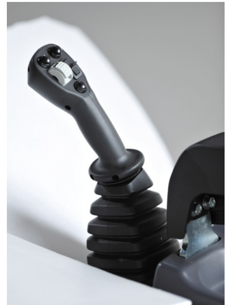
Der multifunktionale Steuerhebel ist die zentrale Schalteinheit.
