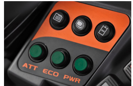
Über die Bedienkonsole können drei Antriebsarten vorgewählt werden.
