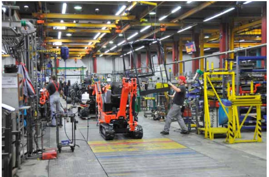
Auf den Montagebändern des modernen Werkes in Zweibrücken werden die Kompaktbagger entsprechend der jeweiligen Modellkonfiguration montiert. Dabei wird neben eigenen Komponenten auch auf namhafte Zulieferer zurückgegriffen. | Foto: Gr/bi
